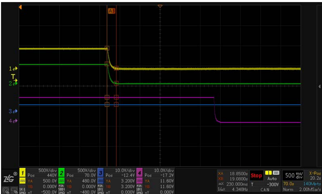
正常充电结束电压泄放时间为 230ms 将输出电压降至 60V 以下
